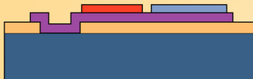
5. Травление слоя \text{Si}_3\text{N}_4 (формирование геометрии мембраны)
