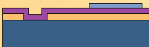
3. Напыление слоя NiCr и его травление (формирование отражающего зеркала)
