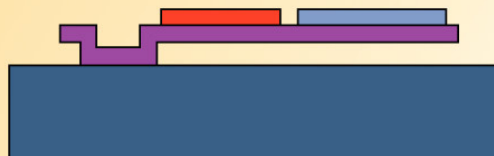
6. Удаление жертвенного слоя \text{SiO}_2
